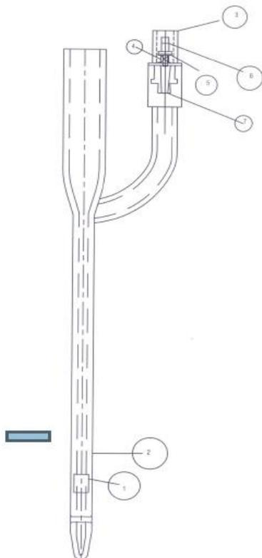
**1** - As Sondas de Foley de 2 e 3 Vias com Balão são confeccionadas em látex de borracha natural, são maleáveis com paredes fortes para evitar torções e colapsos e possuem ponta atraumática.
